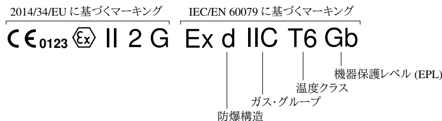
図 7: IEC/EN 60079 に基づくマーキングの例
