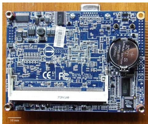
図 1: 基板上に搭載されたバッテリーの例
