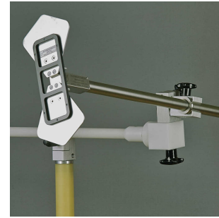
図 56: ISO 11452-9 近接試験用広帯域アンテナの例 (写真は Schwarzbeck 社提供)
