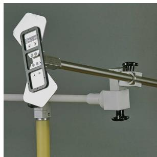
図 60: ISO 11452-9 近接試験用広帯域アンテナの例
