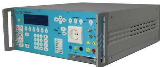
図 22: IEC 61000-4-4, -4-5, -4-11 複合試験器の例 (写真は EMC Partner 社の厚意による)
