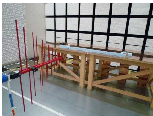
図 10: 車載機器試験用の小型暗室の例
