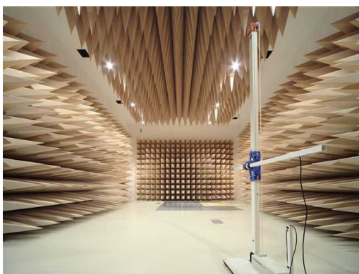
図 7: エミッション測定サイトの例 — 10 m 暗室
