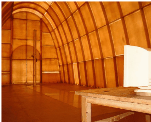
図 6: エミッション測定サイトの例 — 全天候型オープン・サイト
