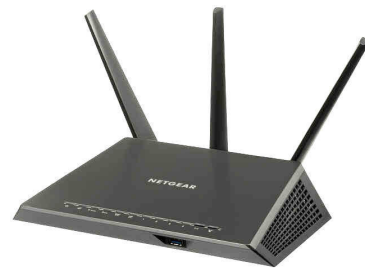
図2: 複数のアンテナを持つ無線 LAN 機器の例
