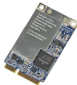
図 5: 内蔵型 (PCI-e 接続) の無線 LAN モジュールの例
