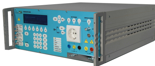
図 12: 単相電源用 CDN を内蔵した複合イミュニティ試験器の例 (写真は EMC Partner 社の厚意による)
