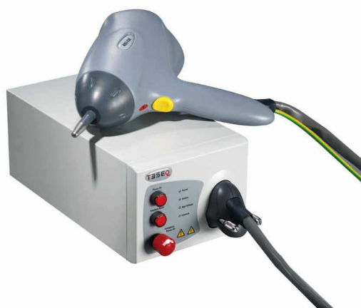
図 2: ESD シミュレータの例 (写真は Teseq 社の厚意による)
