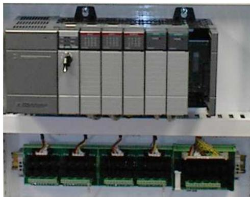
図 1: モジュール型 PLC の例
