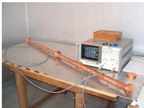
ルからの漏洩の測定の結果への影響を抑えるために測定用チューブ内を引かれる接続ケーブルを金属の延長チューブに通して遮蔽するようになっており、「チューブ・イン・チューブ法」と呼ばれている。
