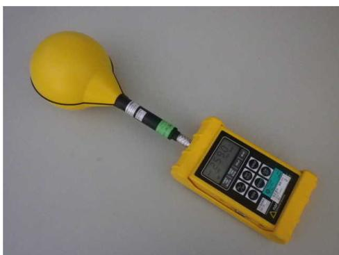
図 6: タイム・ドメイン評価に対応した測定器の例 (Narda ELT-400)
