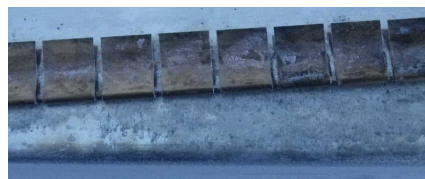
図 23: 塩化カルシウムの存在下で腐食した銅のスプリング・フィンガー (上) とアルミニウムのケース (下)
