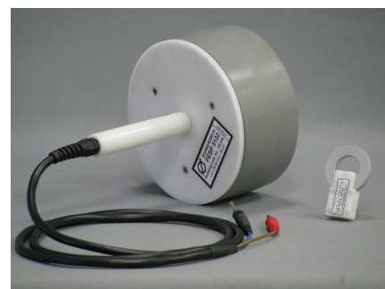
図 11: 120 mm 放射ループ (左) とベリフィケーション用 40 mm モニタ・ループ (右) の例 (写真は Schwarzbeck 社提供)
