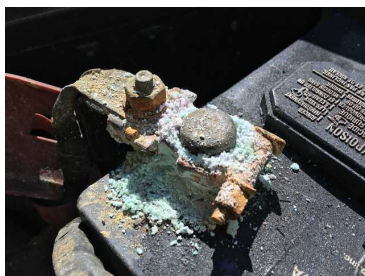
図 12: 腐食したバッテリー端子
